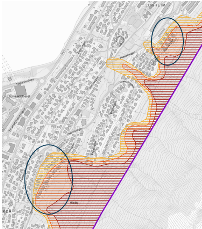
Kart 3 Områder der faresonekartlegging viser eksisterende boliger som ikke oppfyller krav i teknisk forskrift.
