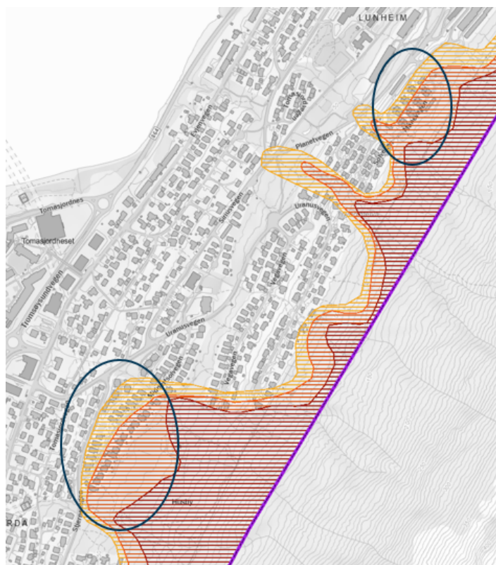
Figur 13 Områder der faresonekartlegging viser eksisterende boliger som ikke oppfyller krav i teknisk forskrift.
