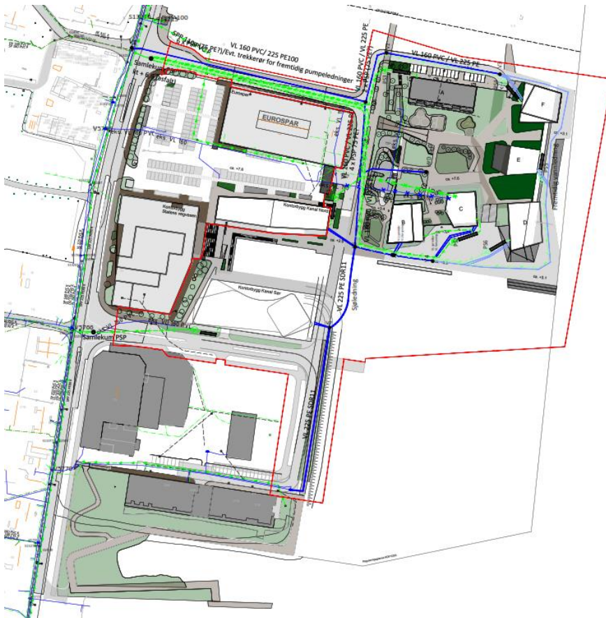
Overordnet VA løsning rød= planområdet, blå= vann, grønn= avløp
